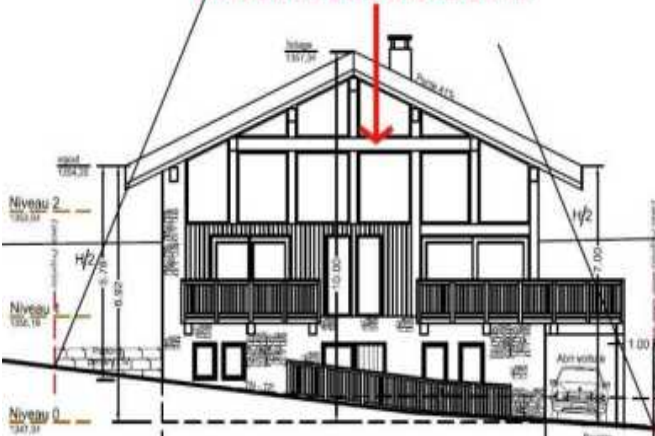
MODIFICATION DE FACADE - TRAVERSE EN BOIS AJOUTE
