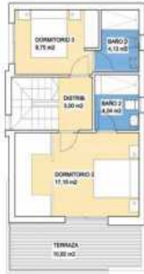
PLANTA PRIMERA SUPERFICIE CONST.-50.24m 2 TERRAZA-10.95m 2
