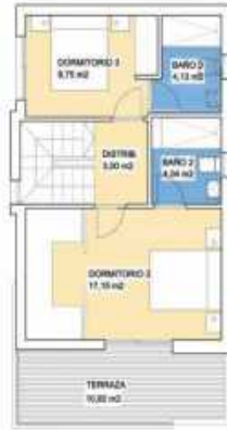
PLANTA PRIMERA SUPERFICIE CONST.-50.24m 2 TERRAZA.-10.95m 2
